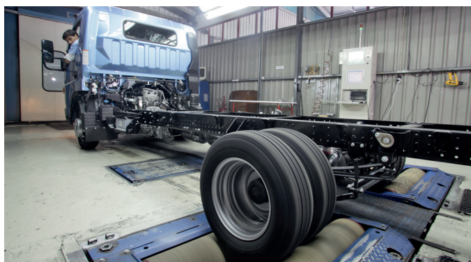
Sur un banc d'essai de freins, on mesure la force de freinage de chaque roue. On calcule le taux de freinage au moyen de la somme de toutes les forces de freinage et du poids.
