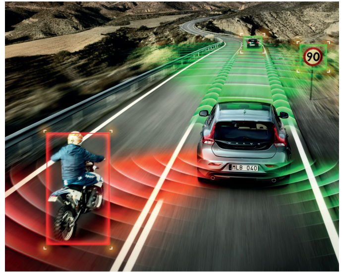
Der Spurwechselassistent unterstützt den Fahrer, in dem der «tote» Winkel schräg seitlich und hinter dem Fahrzeug mittels Sensorik überwacht wird.
