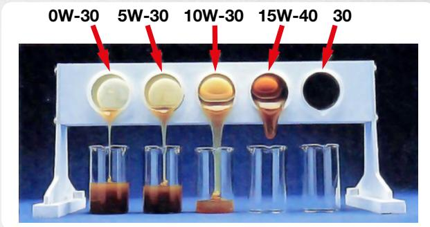
L'illustration présente le comportement à l'écoulement de différentes huiles à une température de -35 °C. Le premier chiffre/nombre suivi de la lettre W pour hiver est déterminant. Une petite valeur indique une huile fluide qui reste facilement pompable même à basse température.
