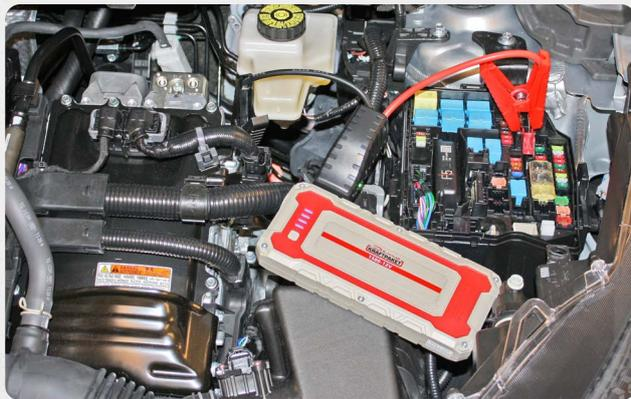
Bei diesem Vollhybridfahrzeug befindet sich die Bordnetz-batterie unter dem Rücksitz. Um im Notfall schnell Starthilfe geben zu können, hat der Sicherungskasten im Motorraum einen plusseitigen Starthilfepunkt. Der Minusanschluss erfolgt über einen Massepunkt. Es genügt dabei eine kleine Fremdbatterie oder eine Powerbank, weil damit nur das Hochvoltsystem freigeschaltet werden muss. Keinesfalls darf über diesen Anschluss jedoch einem Verbrenner Starthilfe gegeben werden.
