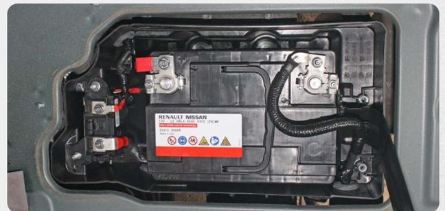
Die 12-V-Batterie dieses Vollhybridautos aus dem Renault-Konzern ist unter dem Kofferraumboden neben der Hochvoltbatterie eingebaut. Mit der verwendeten AGM-Starterbatterie kann auch einem Verbrenner Starthilfe gegeben werden. Auf keinen Fall dürfen dazu aber die Fremdstartpunkte im Motorraum benutzt werden. Diese sind nicht für die hohen Kaltstartströme ausgelegt und dienen nur zum Erhalt von Starthilfe.
