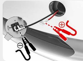
Einige Fahrzeuge haben keinen mechanischen Notschlüssel. Um beim Ausfall der Bordnetz-batterie trotzdem mindestens die Türen öffnen zu können, sind externe Anschlüsse vorhanden. Beim dargestellten Tesla befinden sich diese unter einer Klappe bei der vorderen Stossstange. Die Anschlüsse dienen aber nicht, um einem anderen Fahrzeug Starthilfe zu geben oder um die Batterie zu laden.
