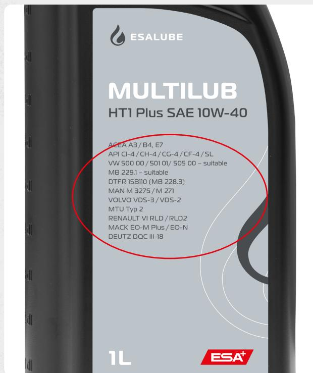
Im roten Kreis sind die API-Spezifikationen dieses ESA-Multilub-Motorenöls angegeben. Die Buchstaben S (Ottomotoren), C (Dieselmotoren) und GL (für Getriebeöle, nicht im Bild) deuten auf die Anwendung des Öls, der nachfolgende Buchstabe kennzeichnet die Leistungsstufe. Darunter sind die verschiedenen Herstellervorgaben aufgeführt, welches dieses Motorenöl erfüllt.
