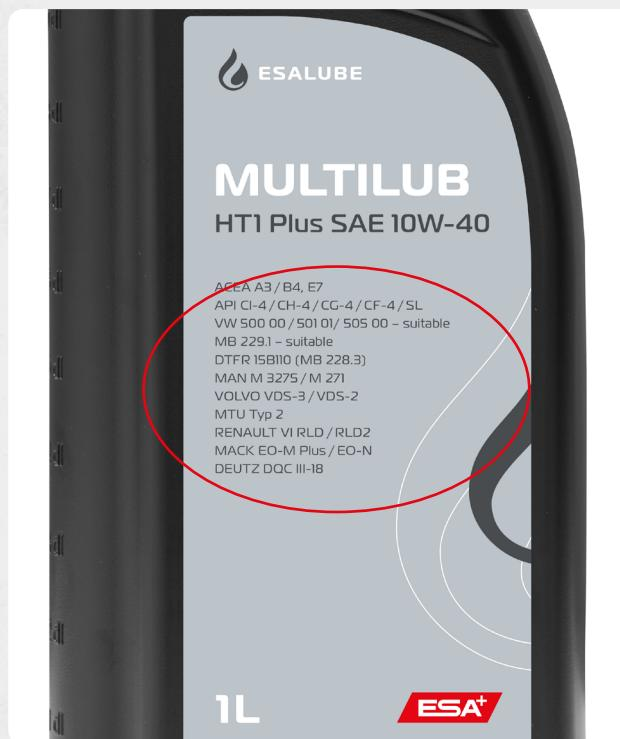
Le cercle rouge indique les spécifications API de cette huile moteur ESA Multilub. Les lettres S (moteurs à essence), C (moteurs diesel) et GL (pour les huiles de transmission, non représentées sur l'image) indiquent l'application de l'huile, la lettre suivante désigne le niveau de performance. Les différentes spécifications du fabricant auxquelles cette huile moteur répond sont indiquées en dessous.
