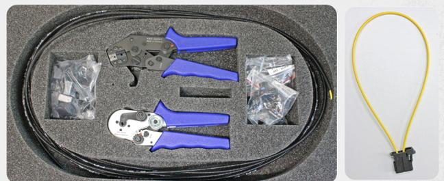
Erlaubt der Fahrzeughersteller die Reparatur des Lichtwellenleiters, sind spezielle Werkzeuge zum Schneiden, Abisolieren und Crimpen der Stecker zu verwenden. Damit keine Schmutzpartikel das Ergebnis verfälschen, ist auf eine absolute Sauberkeit zu achten.
