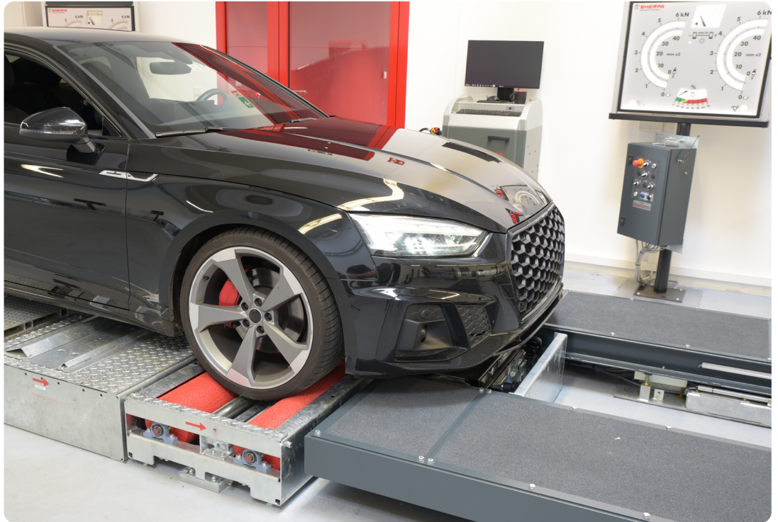
Avant de faire la mesure sur le banc d'essai de frein, il convient de procéder à un contrôle visuel des éléments du système de freinage et de vérifier la pression des pneus.
